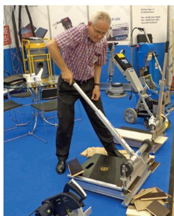
Eine Parkettstanz ermöglicht den Verzicht auf eine Kreissäge.
